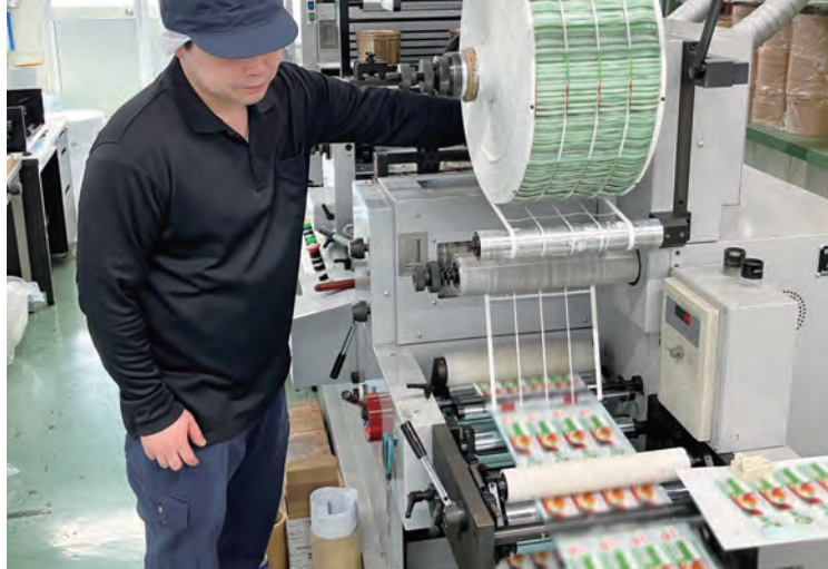
食品シールを手がける和歌山工場。写真は、たまごの“顔”となるパッケージ用シールの型抜き加工の様子です。稼働率は前年比12%増と、生産性の改善が進行中です。
