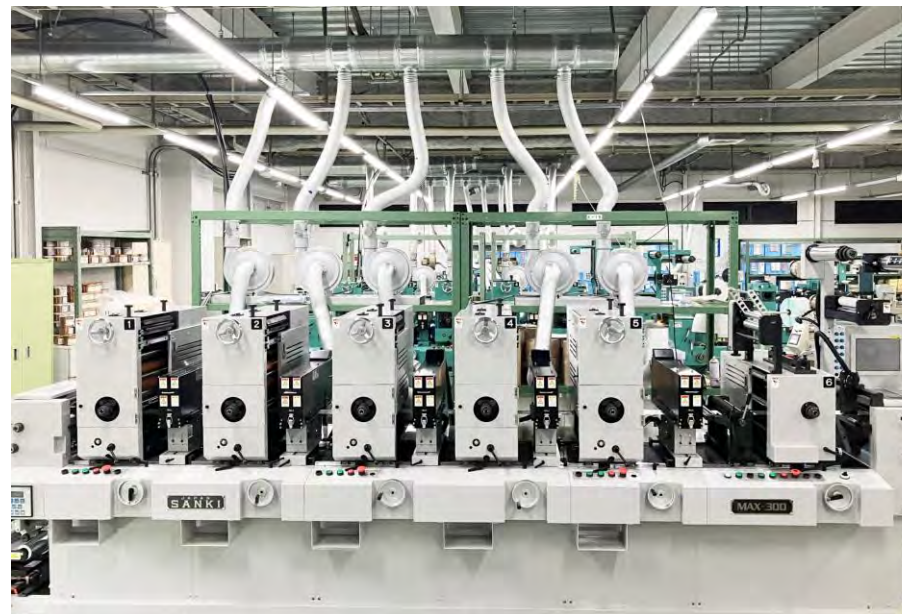
写真:(上) 三起機械 間欠レタープレスラベル印刷機MAX-300 (右) 三起機械 間欠ロータリー加工機SRD稼働の様子
